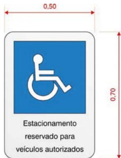
**Figura 71** – Placa para sinalização vertical de vaga reservada em estacionamentos internos
