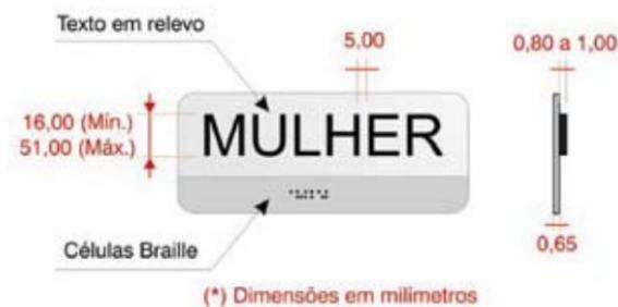
Figura 78 – Dimensionamento básico de placa tátil: vista frontal e lateral
